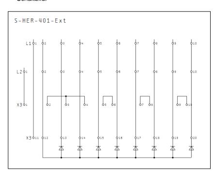
Klemmen 1...20: ext. Steuerstelle anschließen und erforderliche Brücken einlegen
